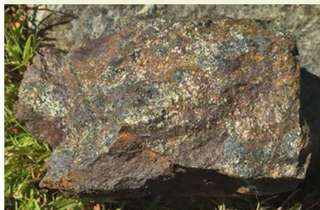
En bit kopparmalm stor som en knytnäve. Malmens koppar förekommer som korn av kopparkis som är mässingsfärgad och ger ett svagt lila skimmer.
